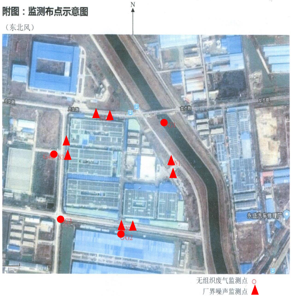
图 3 无组织废气和厂界噪声监测点位图
